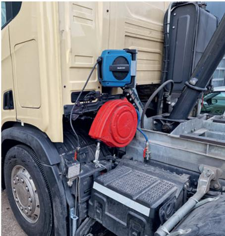
Hinter der Fahrerkabine befindet sich eine zusätzliche Sprühlanze, welche ebenfalls an der Desinfektionsanlage angeschlossen ist und über die Fernbedienung separat aktiviert werden kann.
