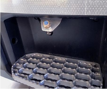
Eine zusätzliche Sprühdüse an der Trittleiste bei der Fahrerkabine ermöglicht ein einfaches Desinfizieren der Schuhsohlen.
