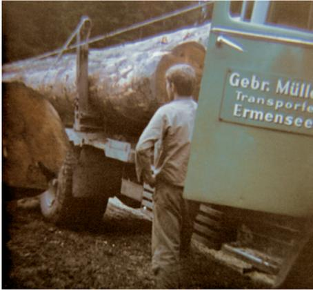
Im Jahre 1972 begann sozusagen die Neuzeit im Rundholz- und Spezialtransport. Mit dem Volvo F 88 mit einem Forstkrane der Marke HMF und mit einem sehr bescheidenen Hubmoment von 7 mt erlebte das Unternehmen für die damalige Zeit einen erneuten Quantensprung im Vergleich zur Seilwinde.
