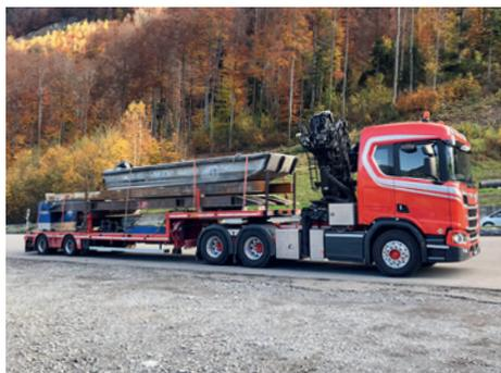
Der Scania R 650 6x4 ist mit einem Wechselsystem ausgerüstet: Langholzschemel kombiniert mit dem Selbstlenker für Langmaterial und eine Sattelkupplung für die Zugkombination mit dem Doll-Semi-Sattelanhängen.
