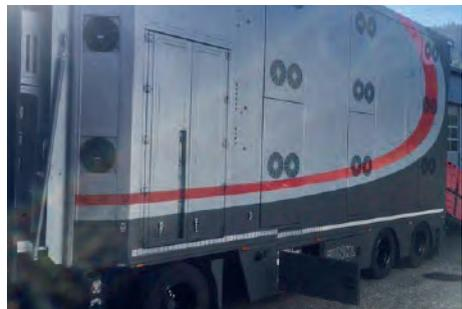
Linke Lüfterseite zieht Luft in Innenraum, rechte Lüfterseite drückt Luft aus dem Innenraum. Der Lüfter hat eine Laufzeit von 4 Stunden, wenn Anhänger abgekuppelt ist.
