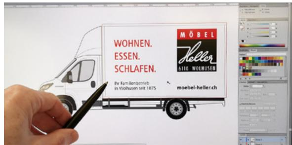
Herstellung der Beschriftungsfolien im Produktionsraum der Rösli Reklame GmbH. Freistehende Schriften werden auf dem Schneideplotter ausgegeben.
