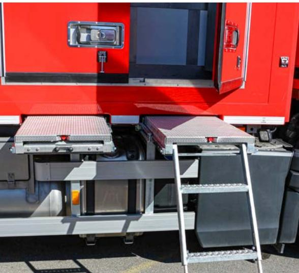
Eine Eigenentwicklung der Ackermann Fahrzeugbau in Willisau, Treppe oder Tablar, je nachdem was gerade benötigt wird.
