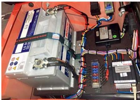
*Einbau und Verkabelung von Zusatzbatterie mit Steuerung und Absicherung des Zubehörs*
