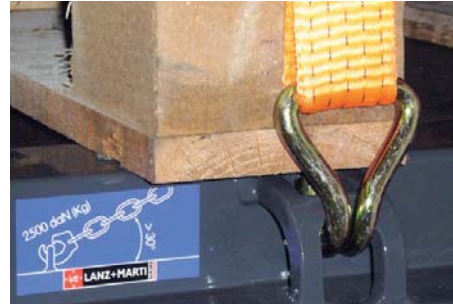
Ladungssicherung Lanz+Marti: nach EN 12640 geprüfte H-Bindelasche
